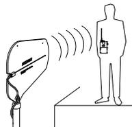
Diese gerichtete, abgesetzt montierbare Breitband-Sendeantenne bietet Funksignal-Abdeckung mit Nieren-Richtcharakteristik. Mit der PA805WB kann ein unbehinderter Funksverbindung zwischen dem Sender und dem Empfänger gesichert werden, wenn die eigentlichen Sender verdeckt sind. Da die PA805WB eine gewisse Verstärkung (aufgrund ihrer Richtwirkung) aufweist, ist sie außerdem nützlich, um sehr große Entfernungen abzudecken.
