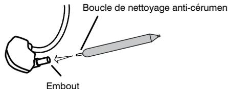
Lors du nettoyage, ne pas faire entrer de force quelque objet que ce soit dans l'embout d'écouteur ! Cela endommagerait le filtre acoustique de l'écouteur.
