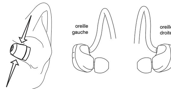
**S'assurer que le manchon recouvre entièrement l'embout des écouteurs.** Si une quelconque partie de l'embout est visible, le manchon n'a pas été correctement installé.
