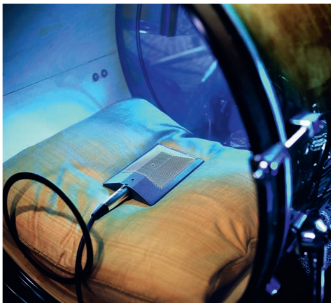
Leichter Aufbau: Das Shure Beta 91A lässt sich einfach ohne Stativ in die Kickdrum legen.
